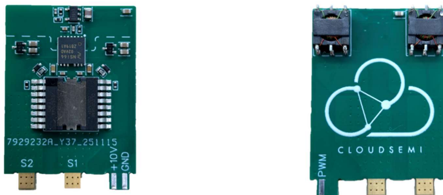
图 17 GaN BDS 器件所在的功率小板（包括驱动和隔离电源）
